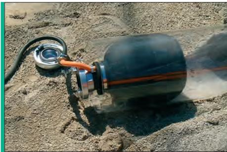
Die Dichtheitsprüfung wird durch unser spezialisiertes Fachpersonal nach den jeweils gültigen Bestimmungen mittels Wasser oder Luft durchgeführt.
